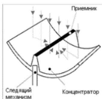
Рисунок 5 - Устройство параболоцилиндрических концентраторов
