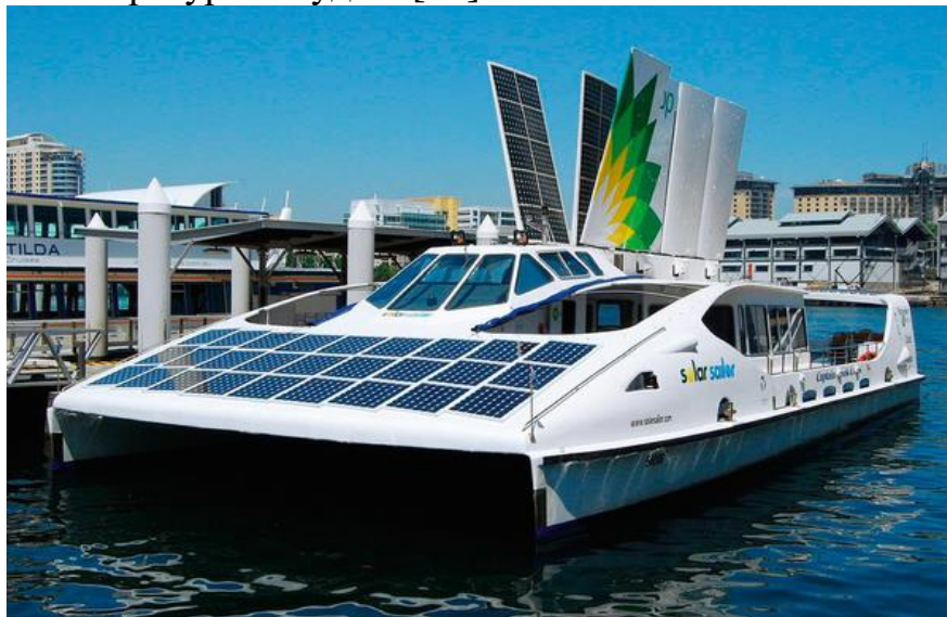
Рис. 3. Пассажирский паром с гибридными ветро-солнечными парусами.
