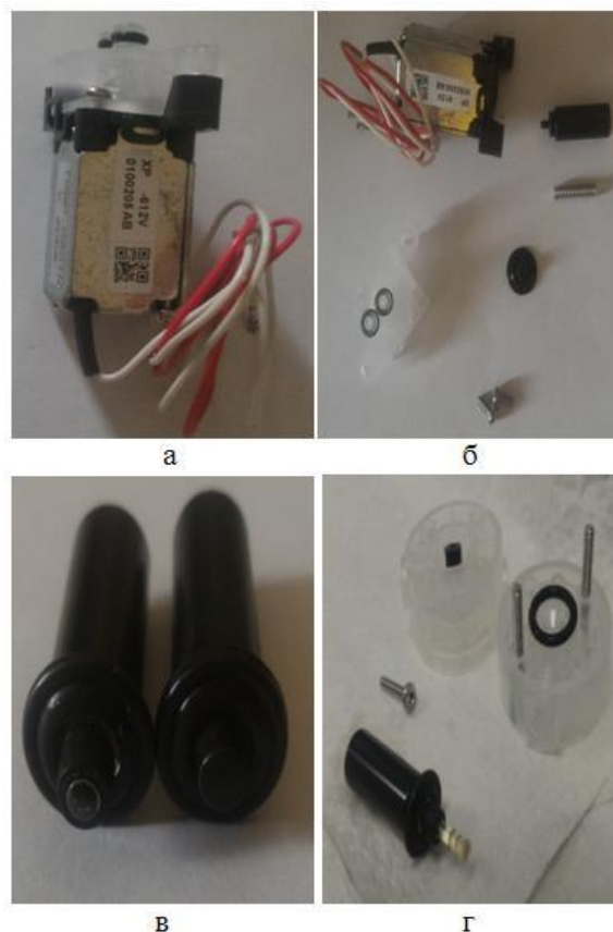
Рисунок 4 Фотографии электромагнитного клапана ХР-612V (а – клапан в сборе; б – составные части клапана; в – сердечник и мембрана клапана; г – форма для получения мембраны)
