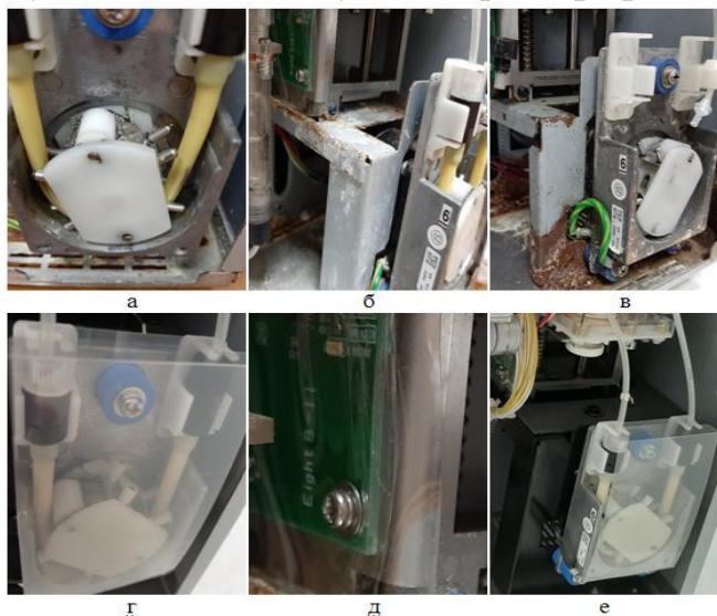
Рисунок 2. Фотографии узлов МЕК-6400 в процессе эксплуатации (а – ротор и насос перистальтического насоса; б, в – следы коррозионного воздействия; г – пластиковая накладка на роторе; д – накладка на плате драйвера мотора; е – вариант исполнения модели МЕК 6500)
