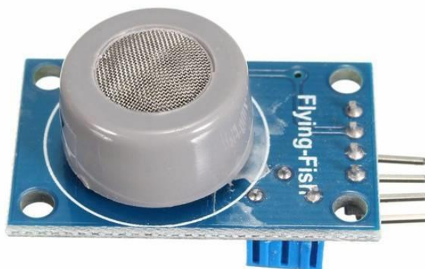
Рисунок 2. Датчик концентрации монооксида углерода MQ-7
