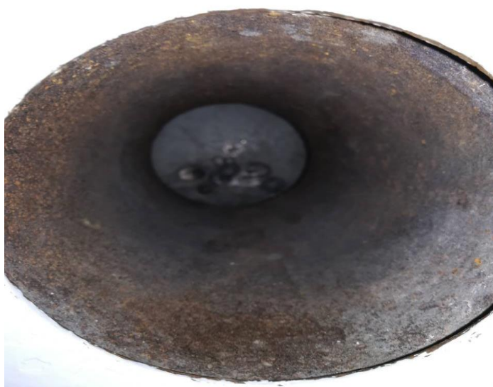
Рис. 6, (5). Пулеулавливатель установленный в специальной комнате аэропорта Домодедово (Москва).
