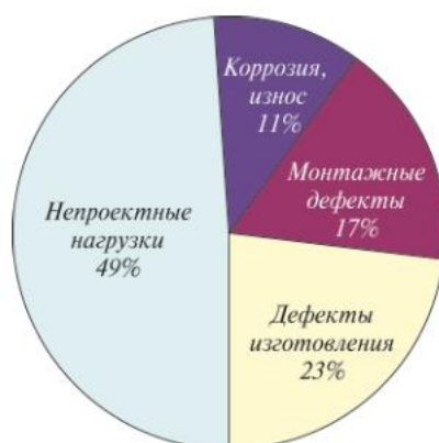
Рисунок 1. Причины аварийных отказов трубопроводов
